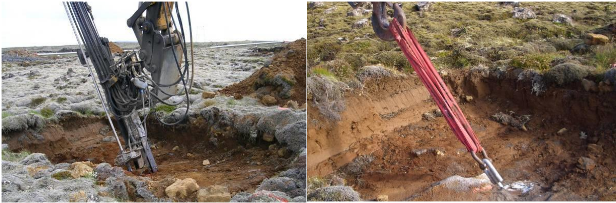
Mynd 7.6 Til vinstri sést hvar borað er fyrir bergbolta. Myndin til hægri sýnir bergboltaprófun.
